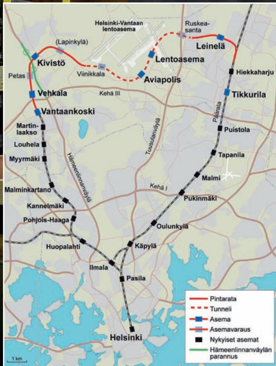
Liikennöinti Kehäradalla käynnistyy kesällä 2015. Radan pituus on 18 km, josta tunnelia 8 km. Radalle tulee ensimmäisessä vaiheessa viisi uutta asemaa: Kivistö, Aviapolis, Lentoasema, Leinelä ja Vehkala. Parhaillaan ollaan rakentamassa asemavaroja Viinikkalaan ja Ruskeasantaan.
